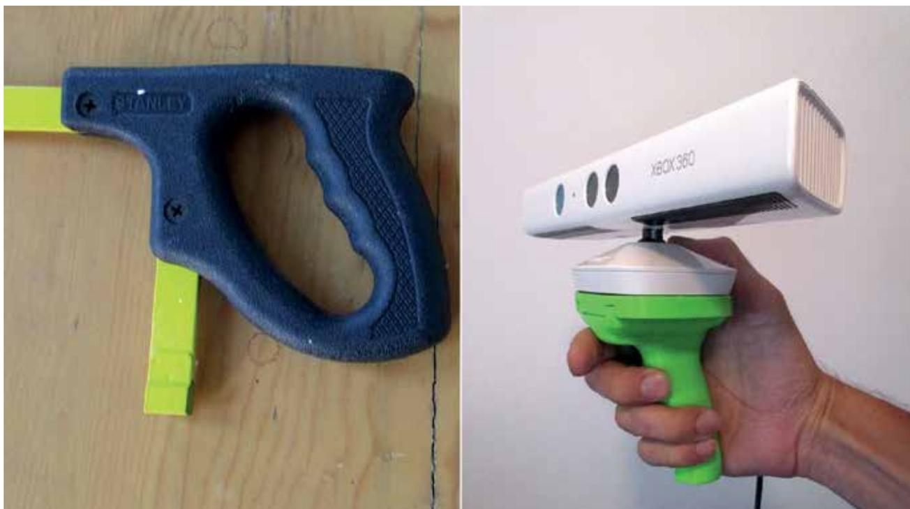
FIGURA 3. ARCO PARA SEGUETA QUE SIRVIÓ DE PUNTO DE PARTIDA PARA DISEÑAR EL MANGO DEL DISPOSITIVO KINECT. -INGENIERÍA INVERSA- (IZQ.) Y SENSOR KINECT CON BASE Y MANGO INSTALADO (DER.). FOTO: CORTESÍA DEL AUTOR.
